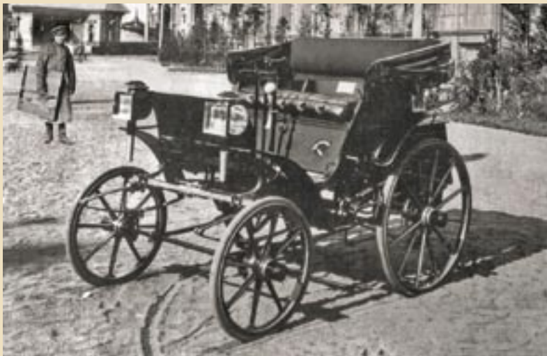
Первый русский автомобиль с двигателем внутреннего сгорания конструкции Евгения Яковлева и Петра Фрезе совершал демонстрационные прездки на Нижегородской выставке
